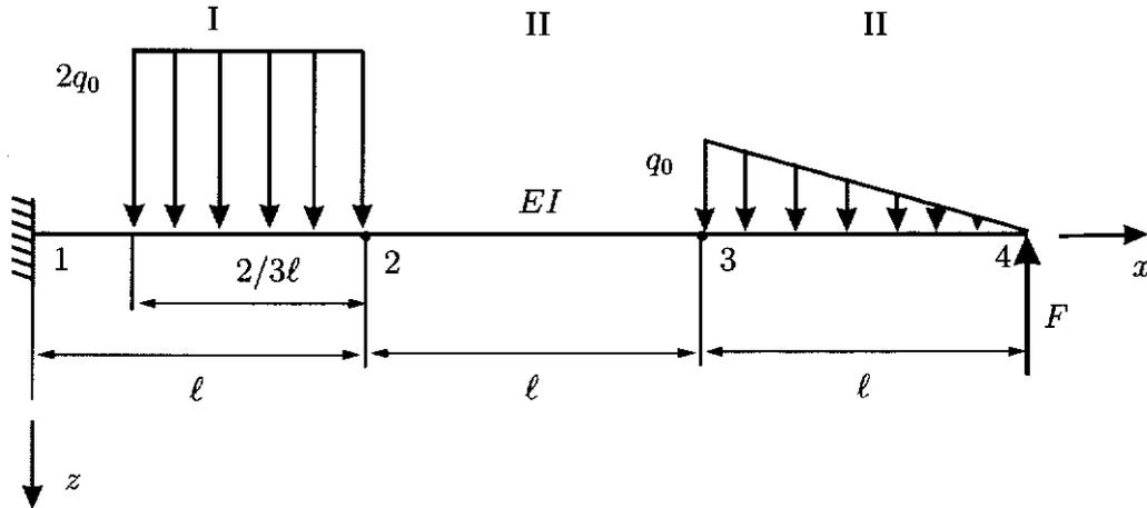
Berechnen Sie aus der gegebenen *Streckenlast* die äquivalenten Knotenlastvektoren mit linearen Formfunktionen für den Balken I sowie den Balken III (jeweils in lokalen Koordinaten des Balkens).
