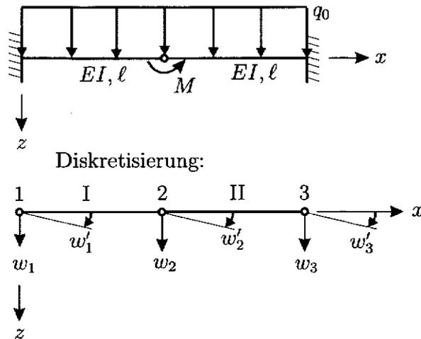
Vervollständigen Sie das Gleichungssystem  $Ku = f$  mit  $u = [w_1 \ w'_1 \ w_2 \ w'_2 \ w_3 \ w'_3]^T$ :
