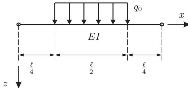
Wie lautet die 3. Komponente des äquivalenten Knotenlastvektors für die gegebene Streckenlast?
