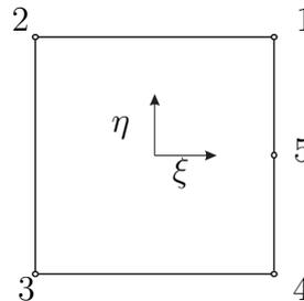
Für das abgebildete 5-Knoten-Element wird ein gemischter Verschiebungsansatz
