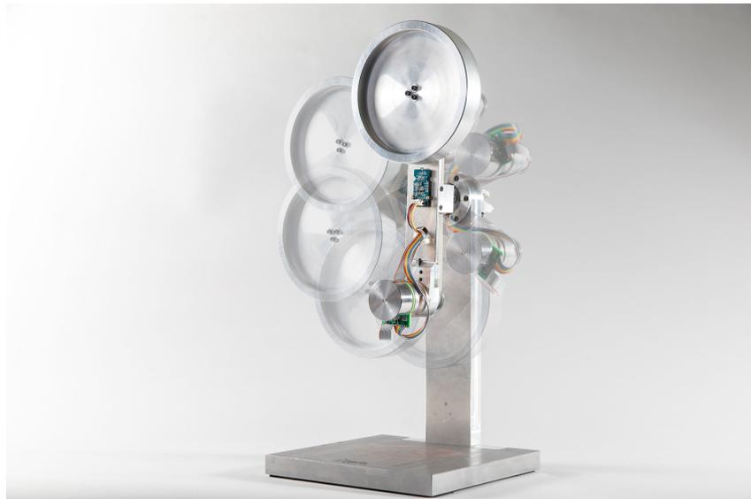
Abbildung 1: Das Pendel mit Schwungrad am INM.
