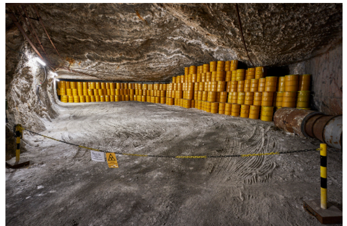
Eingelagerte radioaktive Abfälle
